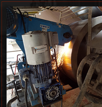
RECTIFICATIONS DE BANDAGES ET GALETS Grinding
